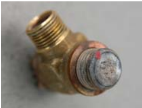
Abb. 1: Defektes Ventil von Triton SLA durch die Verkalkung
